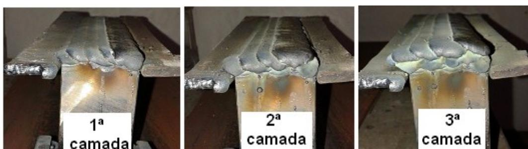
Figura 26 – Sequência de deposição das três camadas de amanteigamento pelo processo MIG.
