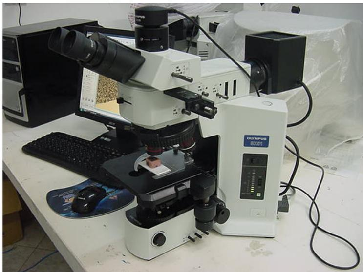
Figura 28 – Microscópio ótico Olympus BX51.
