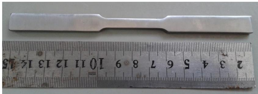
Figura 39 – Corpo de prova de tração com parte útil usinada por eletroerosão a fio.
