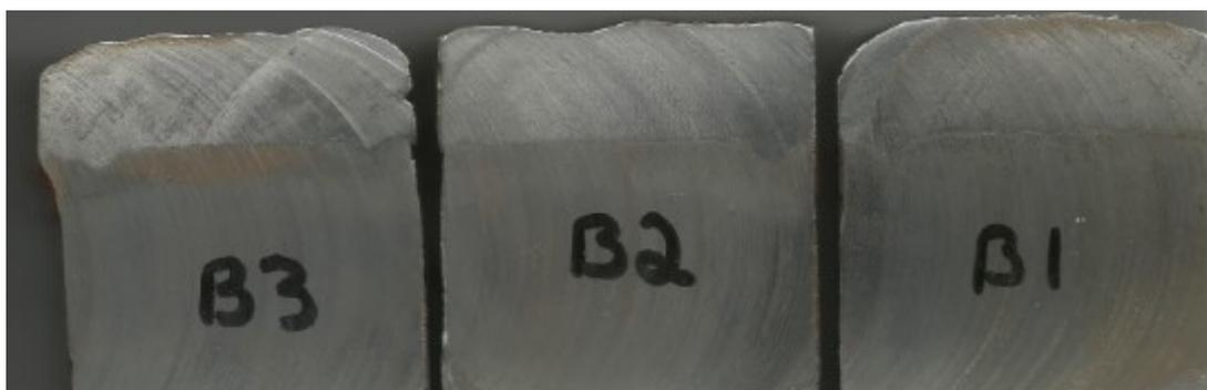
Figura 27 – Corte transversal das amostras amanteigadas.
