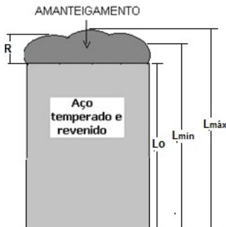
Figura 42 – Dimensões da chapa amanteigada.
