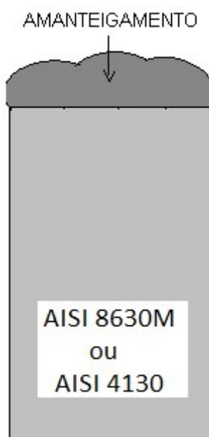
Figura 24 – Esquema do amanteigamento dos aços de elevada resistência.
