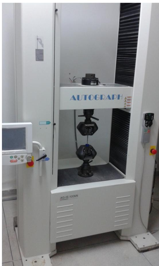
Figura 41–Máquina de ensaio de tração da Shimadizu.
