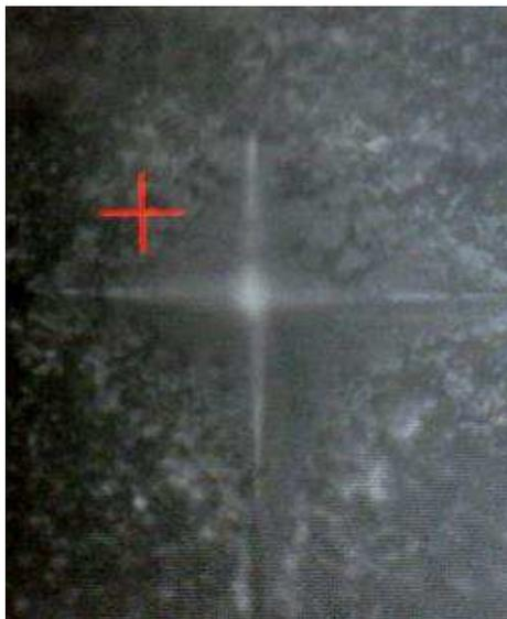
**Figura 7:** Ilustração da endentação de microendentador Vickers em corpo de prova produzido com resíduo de zircônia.
