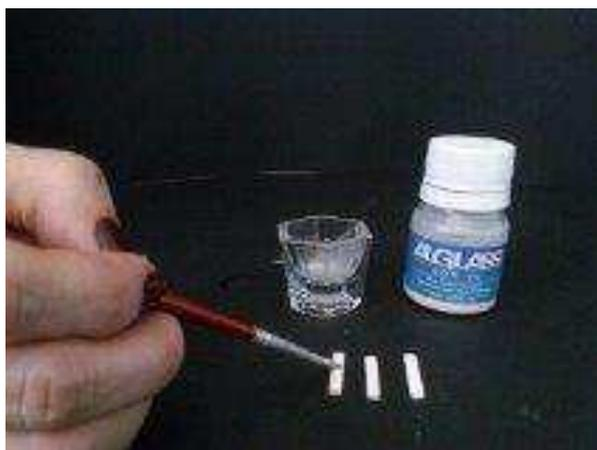
**Figura 6:** Adição de pó de vidro aos corpos de prova de zircônia pré-sinterizados.
